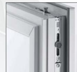
ActivPilot Control - Der spezielle Kontaktverschluss auf dem Fensterrahmen in Verbindung mit dem vorbereiteten Fensterbeschlag ermöglicht es Ihnen die Position des Fensters zu überwachen. Dies kann mit Geräten wie der Klimaanlage, der Dunstabzugshaube oder der Alarmanlage kombiniert werden. Alle Komponenten (z.B. den passenden Verschlusssensoren) sind zwischen Fensterflügel und Rahmen versteckt.
